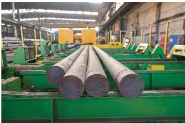
Bloky polotovaru z procesu kontinuálneho odlievania tvoria východiskový materiál na výrobu bezšvových oceľových rúr.
